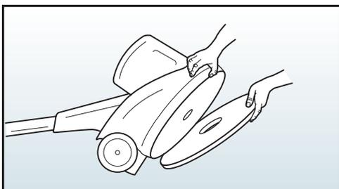
Pad nach Gebrauch immer von der Maschine entfernen (nicht unter der Maschine lassen)
