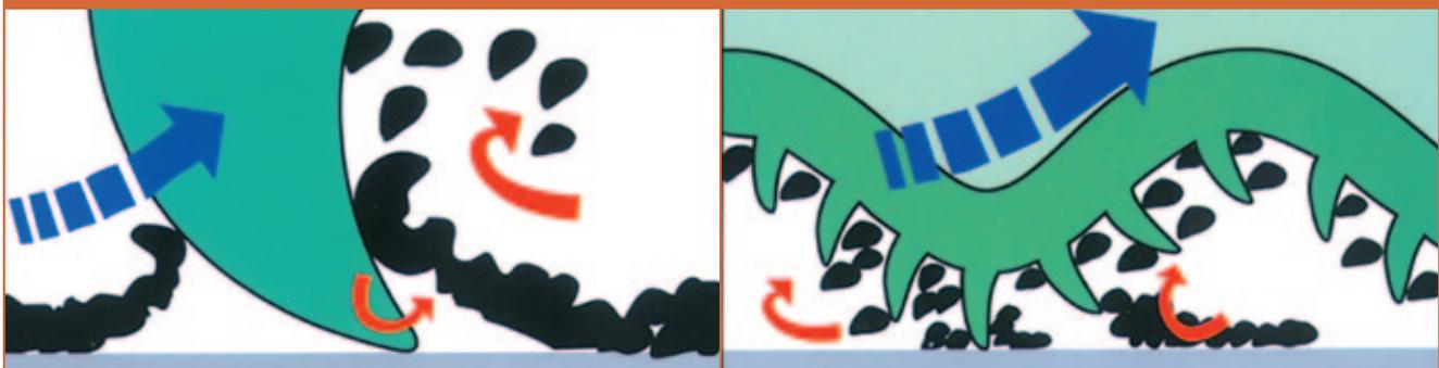
Der Schmutzbelag wird nicht abgeschliffen, sondern aufgebrochen und von der wellenförmigen Oberfläche abgetragen – ohne zu kratzen!\*
