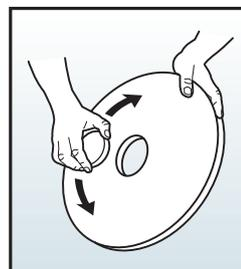
Padoberfläche mit dem Innenloch-Pad (nicht mit einer Bürste reinigen)
